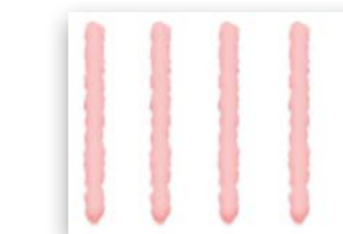
Lepení izolačních desek - výtěžnost 14 m 2 (pro desky XPS jako zateplení spodních částí staveb i pod úrovní terénu.)
